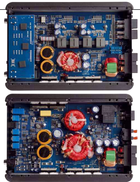
Die Four (oben) arbeitet mit zwei Verstärker-ICs unter der Platine. Die One setzt auf separate Leistungstransistoren
